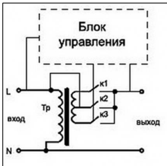
Рис.3 - Релейный стабилизатор напряжения. Схема функциональная
