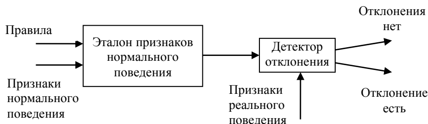
Рис. 4.1. Обнаружение признаков аномального поведения защищаемой системы
