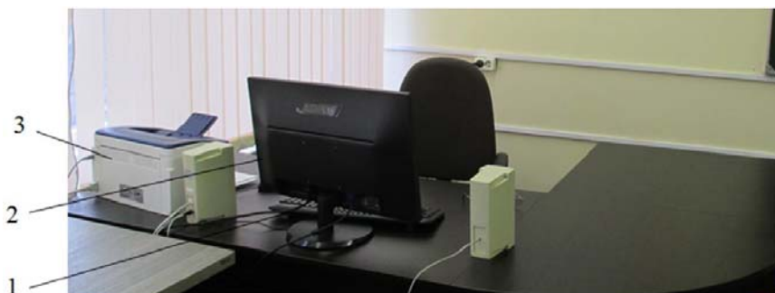
Рис. 1.13. Рабочее место диспетчера/администратора АТП: 1 – компьютер; 2 – видеомонитор со звуковыми колонками и гарнитурой переговорного устройства; 3 – принтер
