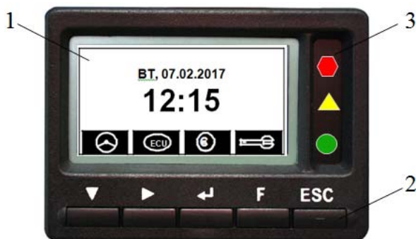
Рис. 1.14. Внешний вид БСКД: 1 – ЖК-экран; 2 – клавиши; 3 – табло светодиодов
