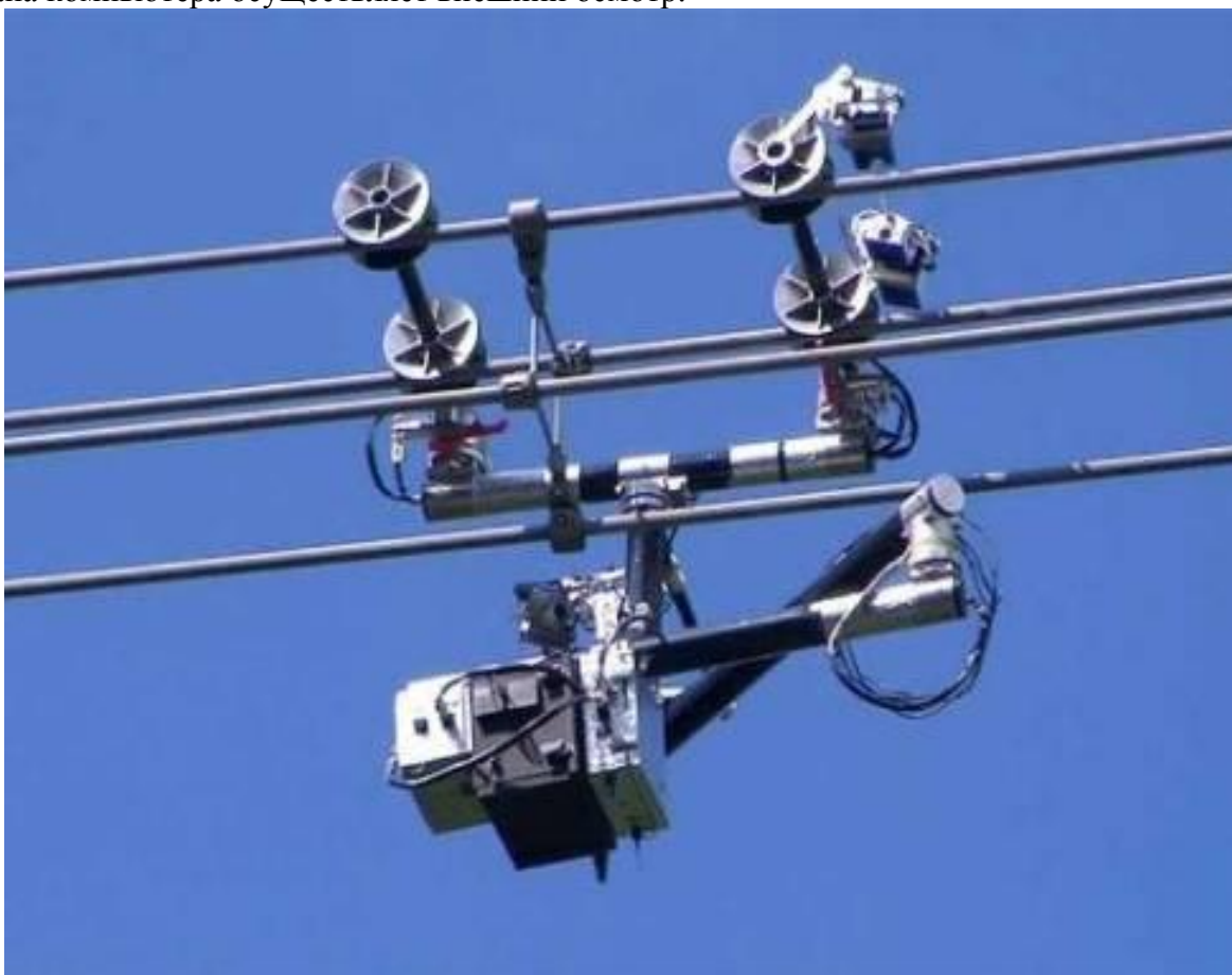
Рисунок 1 – Машина для диагностики и обслуживания ЛЭП
