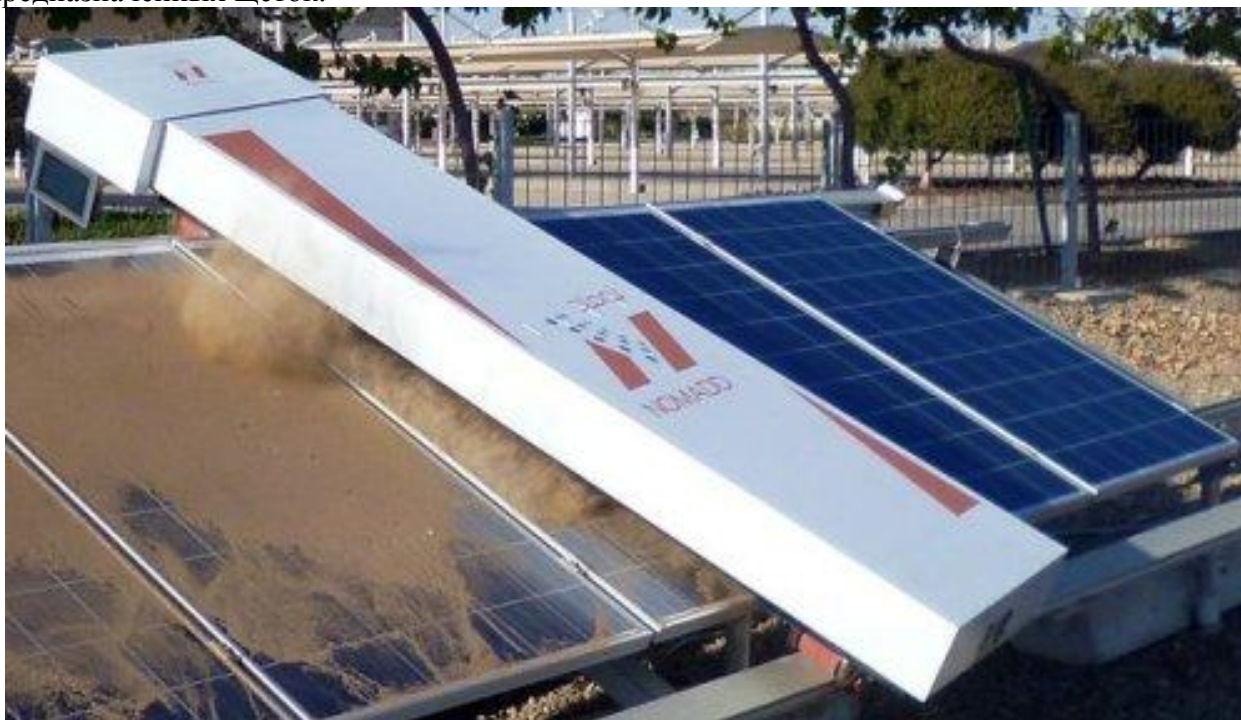
Рисунок 2 – Безводный механический автоматизированный прибор для удаления пыли
