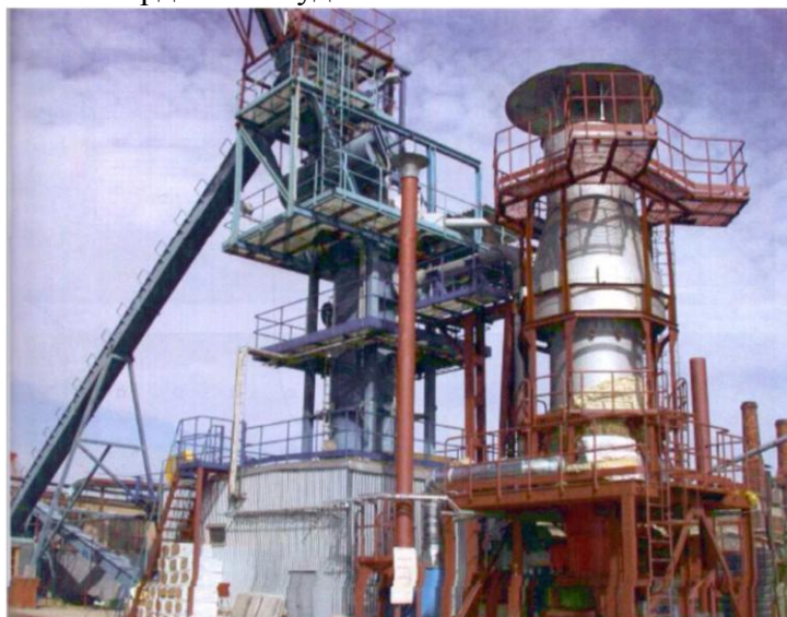
Рисунок 2 – Газификатор в комплекте со сжигающим устройством на экспериментальной площадке ФГУП ММПШ «Салют»
