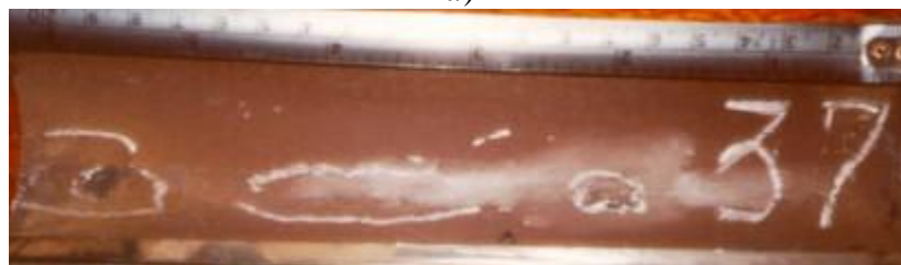
Рисунок 2 – Результаты контроля экранной трубы 60х6 мм фронтного экрана котла ТГМП-206
