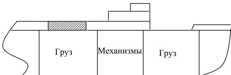
Рис. 9.5. Схема удифферентовки путем изменения архитектурного типа судна
