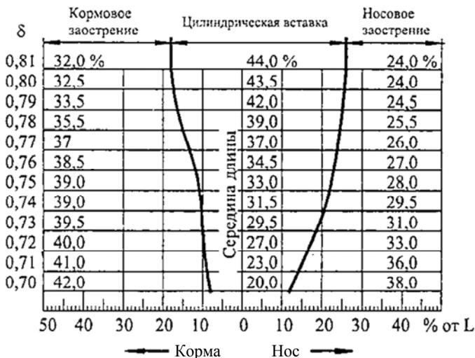
Рис. 8.3. Длина и положение цилиндрической вставки
