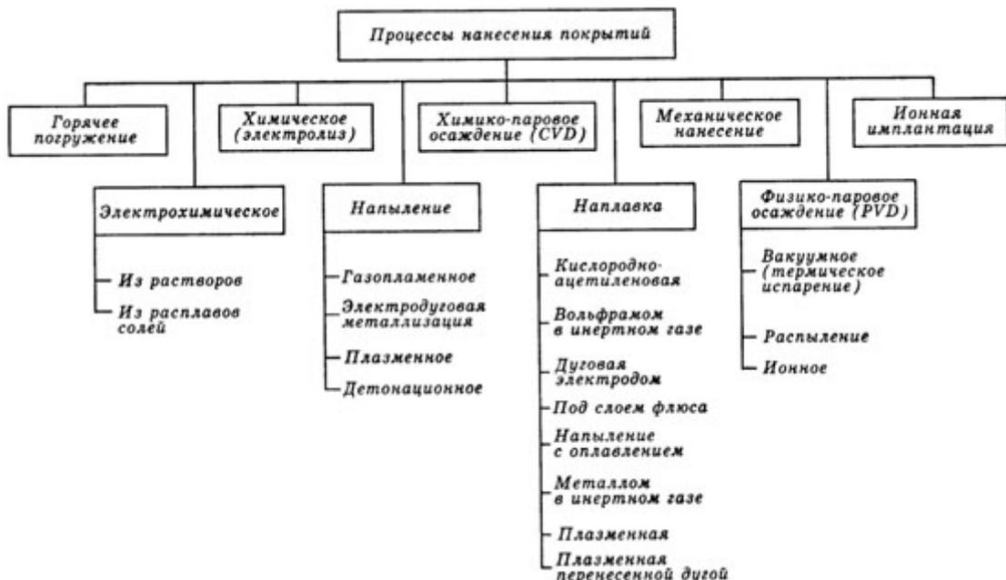
Рисунок 2.1 – Классификация процессов нанесения металлических покрытий
