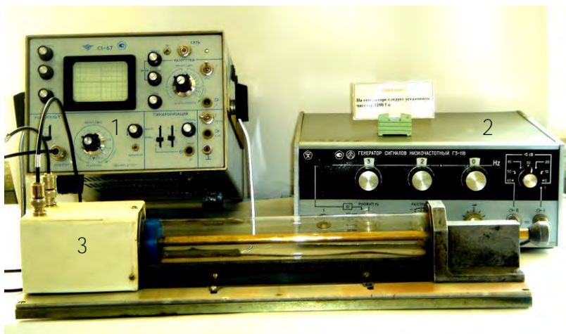
Рис. 5. Экспериментальная установка: 1 – осциллограф; 2 – генератор колебаний; 3 – измерительный стенд
