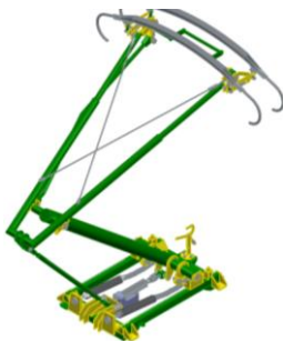
Рисунок 2 – Предлагаемая конструкция полупантографа
