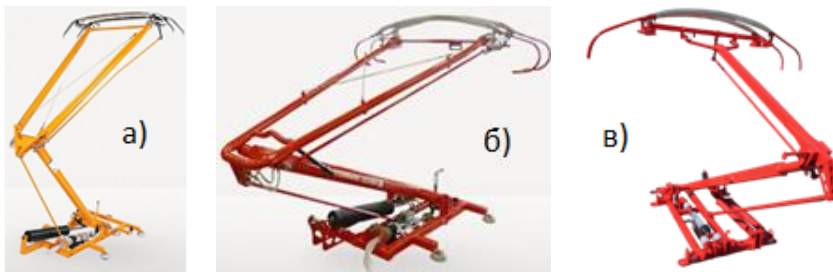
Рисунок 1 – Токоприемники подвижного состава
