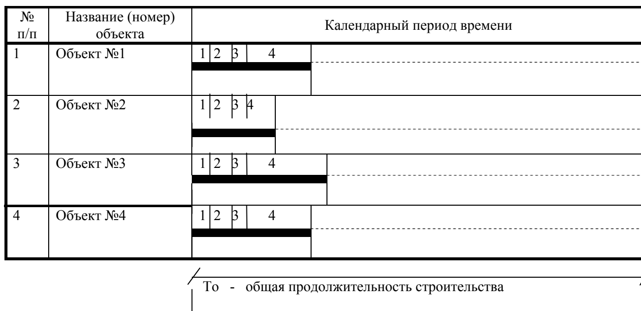
Рис. 2. Схема линейного графика при параллельном способе строительства
