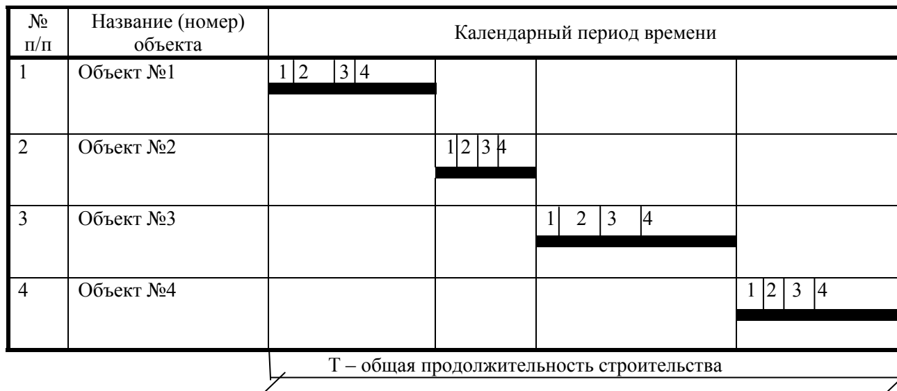
Рис. 1. Схема линейного графика при последовательном способе строительства.
