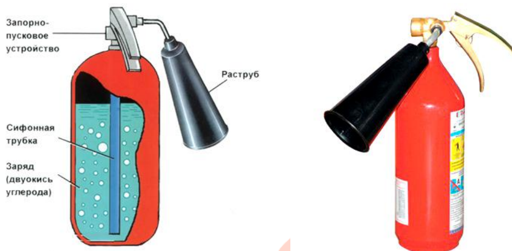
Рис. 2.1. Огнетушитель углекислотный
