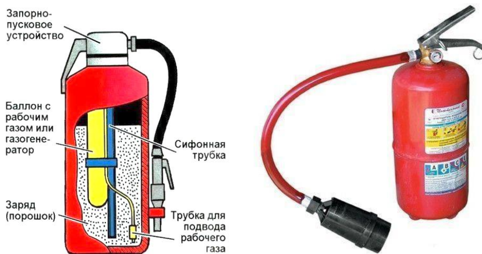
Рис. 2.2. Огнетушитель воздушно-пенный
