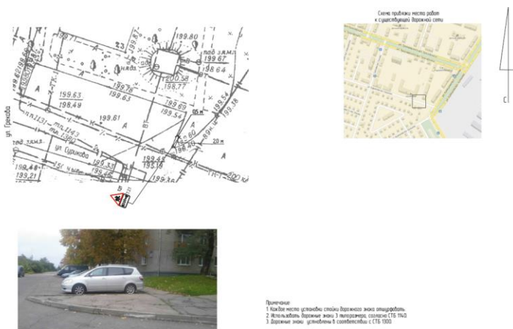
Рисунок 1 – Схема установки дорожных знаков на участке ул. Сурикова
