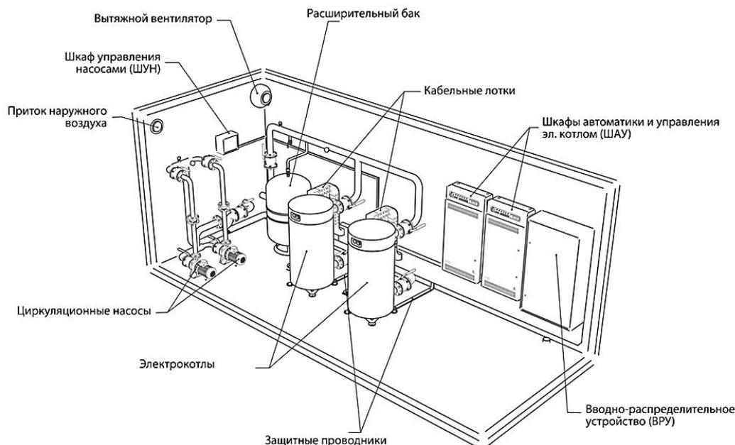
Рисунок 1 – Принципиальная схема электродотельной.
