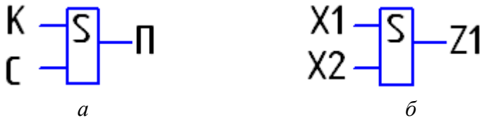
Рис. 6. Представление цифровой схемы как конечного автомата: a – для схемы на рис. 3, б – общее представление
