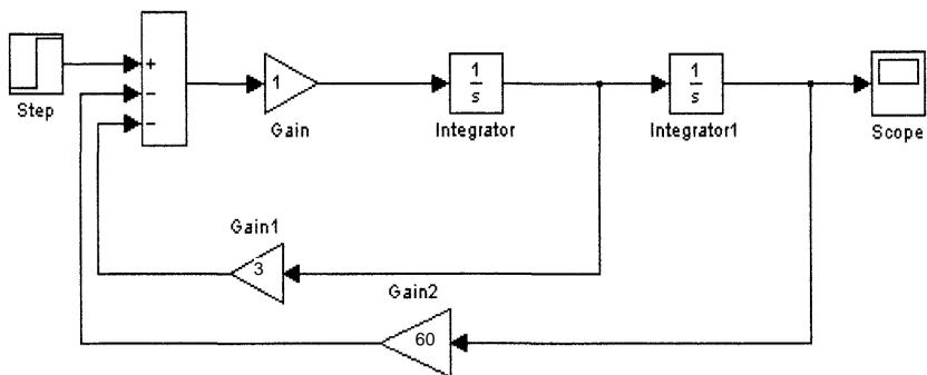
Рис. 16. Блок-схема решения дифференциального уравнения второго порядка (3)
