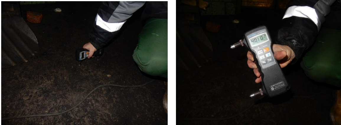
Рисунок 1 – Пример использования ультразвукового дефектоскопа
