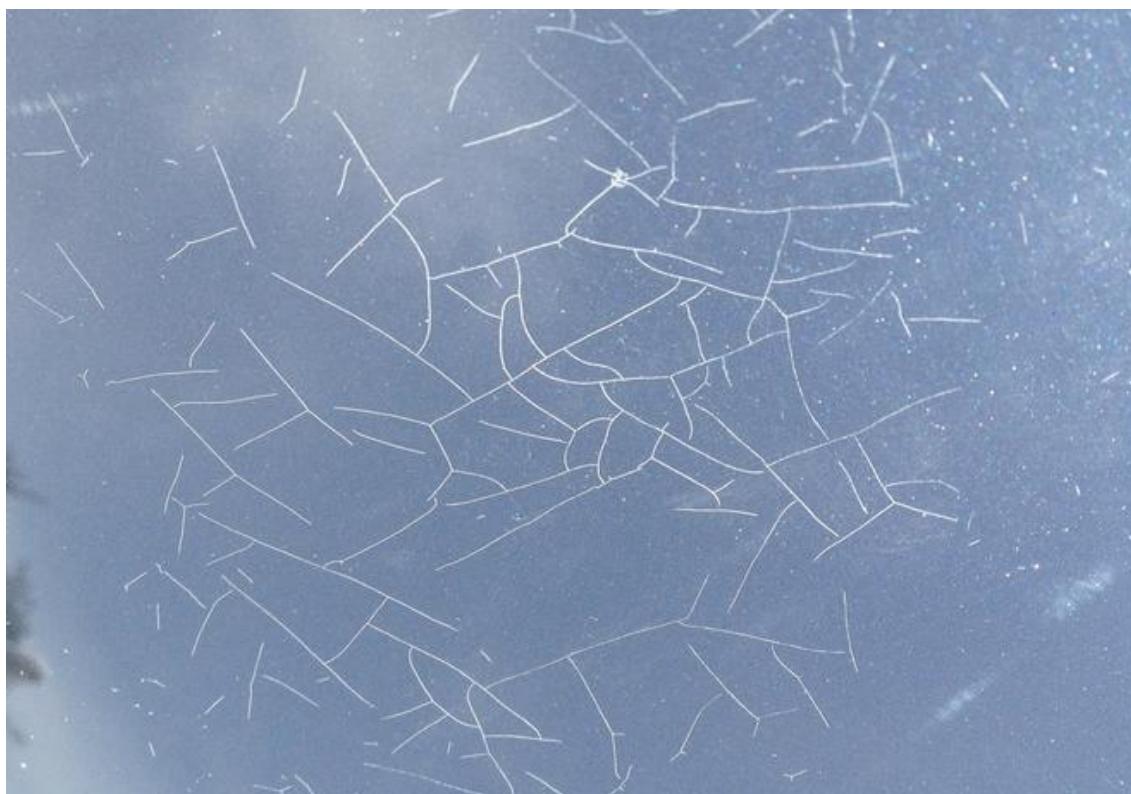
Рисунок 1 – пример растрескивания тензочувствительного покрытия
