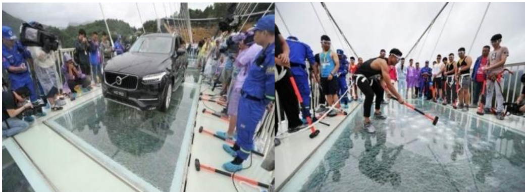
Рисунок 7 – Показательные испытания моста на прочность
