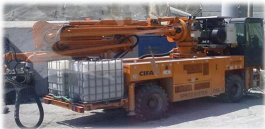
Рисунок 6 – самоходная машина для нанесения набрызг-бетона
