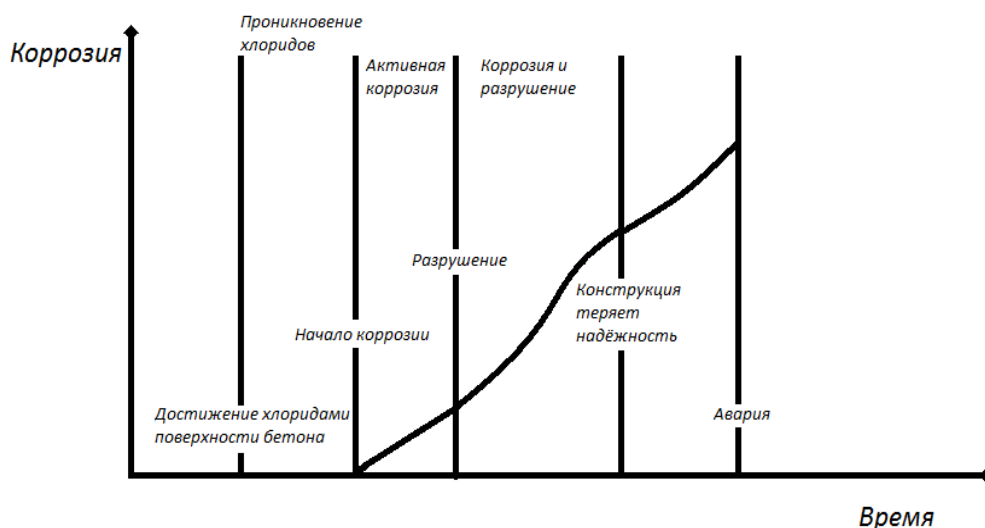
Рисунок 2 – Коррозионное разрушение железобетона от действия хлоридов
