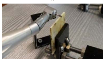
Рисунок 3 – Принципиальная схема устройства для определения режущей способности бора (а) и фотография его рабочей зоны (б)
