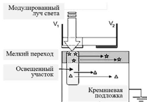
Рисунок 1 – Измерение поверхностного сопротивления двухэлектродным электрометрическим зондом
