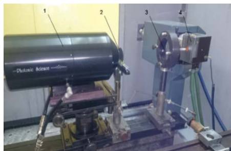
Рисунок 2 – Фотография стенда для фокусировки рентгеновского излучения. 1 – рентгеновская камера; 2 – сетка; 3 – линза Кумахова в гониометре; 4 – источник рентгеновского излучения
