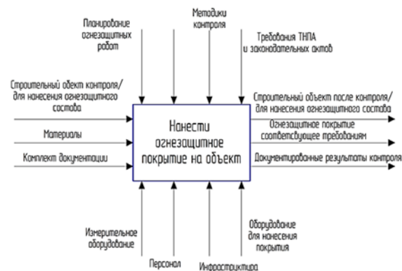
Рисунок 1 – Процесс обеспечения контроль качества огнезащитных работ
