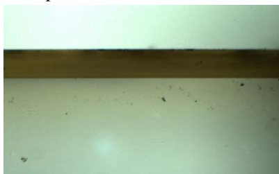
Рисунок 1 – Фотография монокристаллического слоя, активированного ионами гольмия, выращенного на кристалле KY(WO_4)_2
