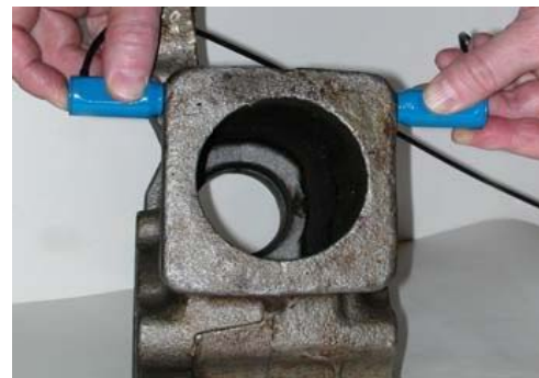
Рисунок 1 – Пояснение к схеме отбраковки высокопрочного чугуна от серого теневым методом
