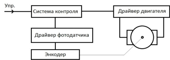
Рисунок 2 – Блок-схема сервопривода с оптической обратной связью
