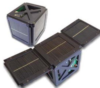
Рисунок 3 – Внешний вид ЭО МСР-08 с закрытыми и раскрытыми панелями солнечных батарей
