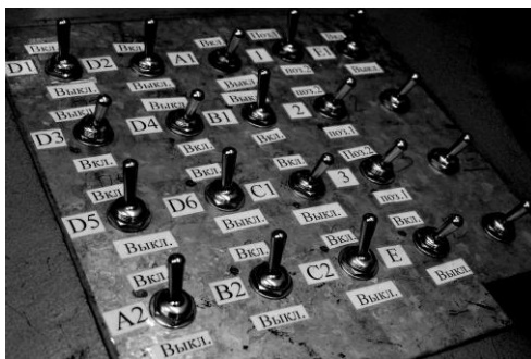
Рисунок 3.10 – Блок управления имитацией неисправностей и переключением режимов работы генераторной установки
