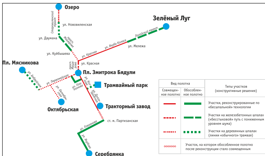
Рисунок 2 – Характеристики трамвайных путей в г. Минске
