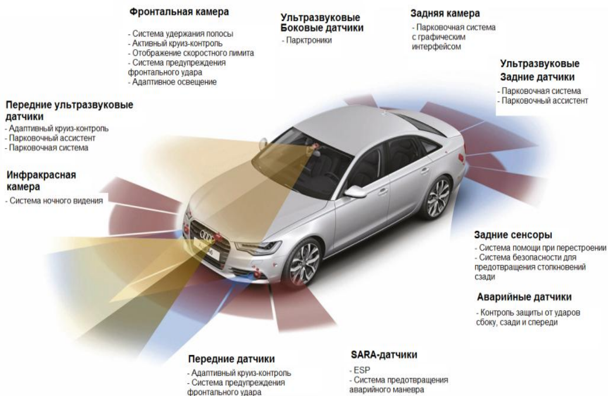
Рисунок 7 – Составляющие систем безопасности автомобиля
