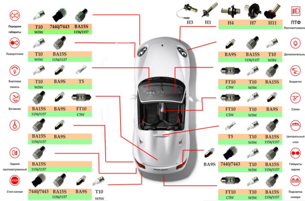
Рисунок 5 – Элементы светотехники автомобиля
