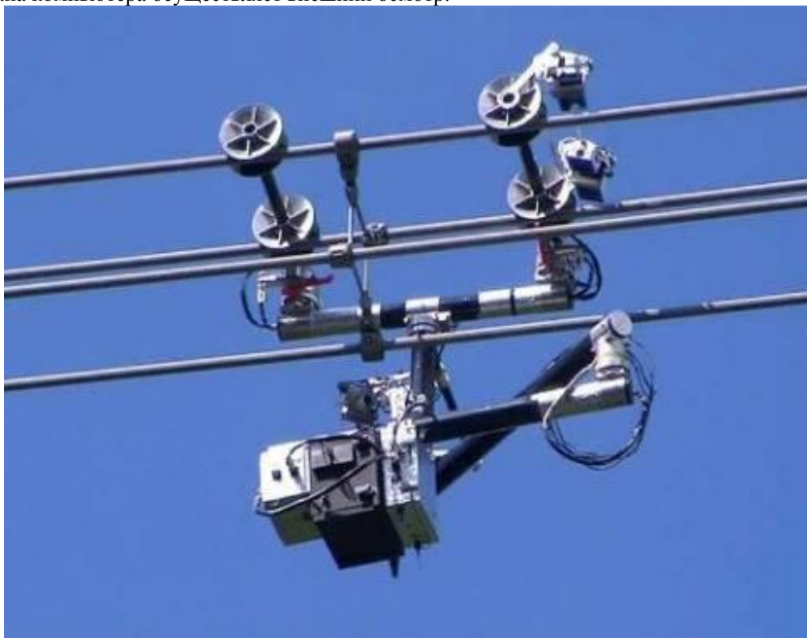
Рисунок 1 – Машина для диагностики и обслуживания ЛЭП
