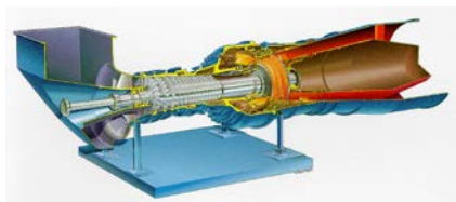
Рис. 3.3. – Принципиальная схема ГТУ
