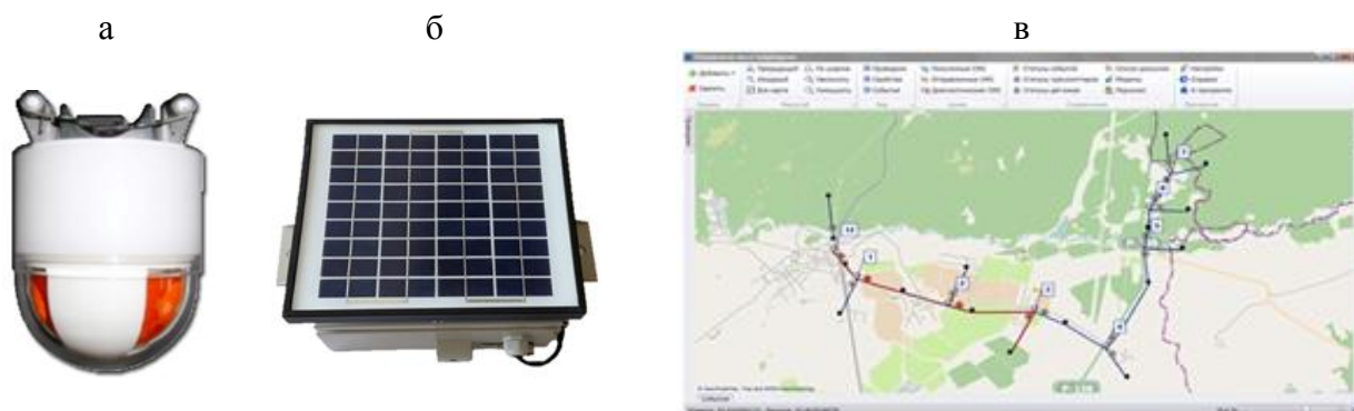
а – индикатор повреждения воздушной линии; б – трансмиттер; в – программный продукт топографического ОМП Рисунок 1 – Элементы геоинформационная системы ОМП
