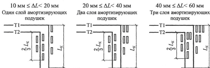
Рис. 2.24. Схема установки амортизирующих подушек
