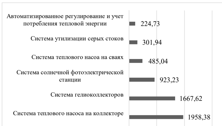
Рисунок 1 – Среднее арифметическое значение инвестиционных затрат на реализацию мероприятий повышения энергоэффективности жилых домов в расчете на 1 квартиру, долларов США [1].
