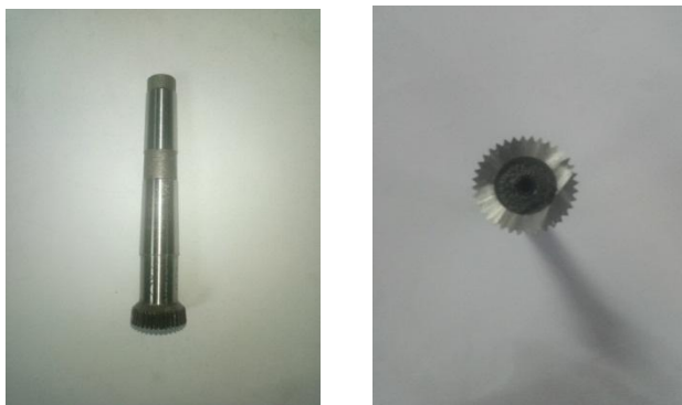
Рисунок 3 – Долбяк хвостовой для изготовления детали «винт»
