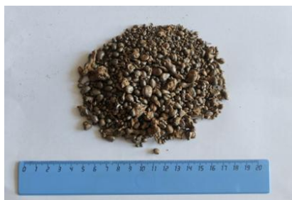
Рисунок 1 – Армирующие чугунные гранулы
