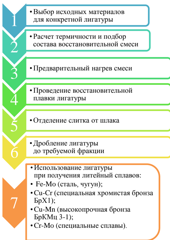
Рисунок 2 – Технологическая схема получения и применения лигатур на основе молибдена, хрома и марганца
