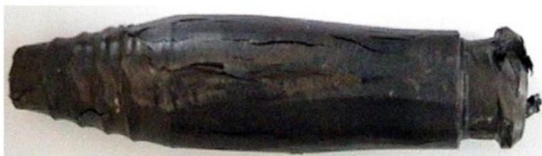
Рисунок 2 – Осевое разрушение материала с выходом трещин на поверхность прокатанной детали
