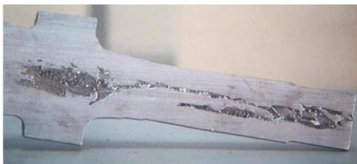
Рисунок 4 – Осевое разрушение материала
