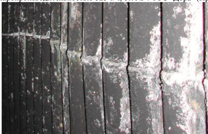
Рисунок 3 – Массовый прогиб экранных труб газоплотной панели в зоне монтажных стыков
