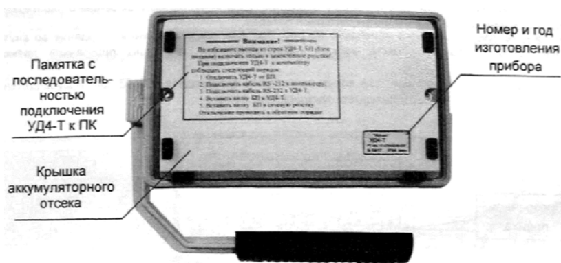
Рис. 13. Задняя панель УД4-Т
