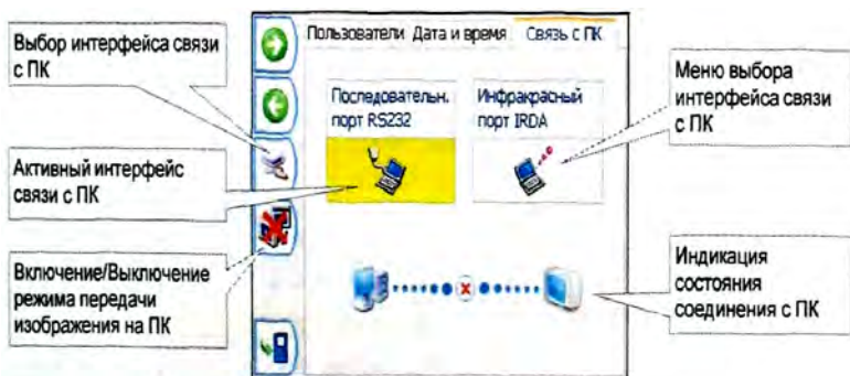
Рис. 28. Окно установления соединения с ПК
