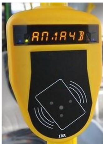
Рисунок 6 - Терминал бесконтактных карт
