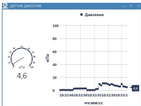
Рисунок 2 – Информационное окно ПК в режиме контроля дифференциального давления
