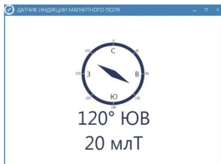
Рисунок 4 – Информационное окно ПК в режиме контроля индукции постоянного магнитного поля
