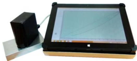
Рисунок 1 – Прибор ИСУМ-1 для динамического индентирования материалов
