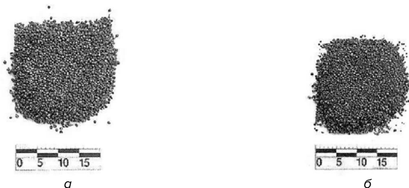
Рис. 1. Внешний вид металлических отходов производства: а – чугунная дробь ДЧЛ 08; б – чугунная дробь ИЧХ28Н2
