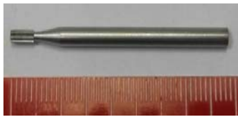
Рисунок 3 – Фотография стального зубного бора, примененного в исследованиях
