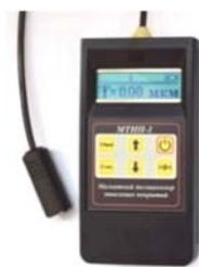
Рисунок 2 – Доработанный магнитодинамический толщиномер МТНП-1, оснащенный размагничивающей системой
