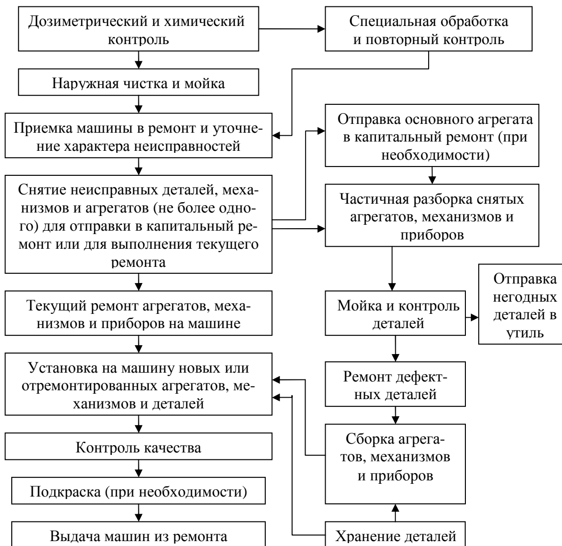
Рисунок 2.5 – Технологический процесс текущего ремонта машин
