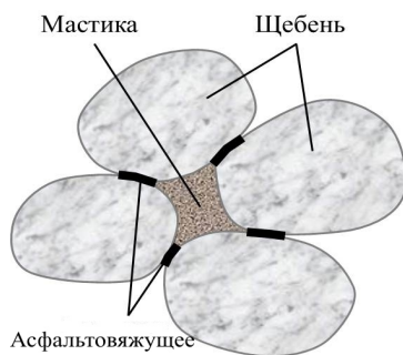
Рис. 2. Структура реального асфальтобетона Fig. 2. Structure of real asphalt concrete
