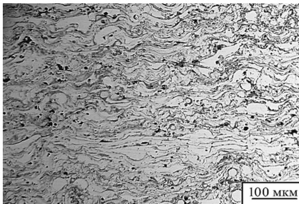
Рис. 1. Характерная микроструктура газотермического покрытия из стали 95X18
