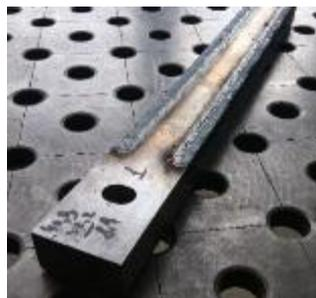
Рис. 2. Заготовка противобруса после наплавки
