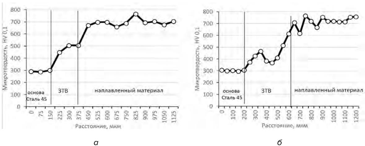
Рис. 6. График распределения микротвёрдости в поперечном сечении заготовки после однопроходной (а) и многопроходной (б) наплавки
