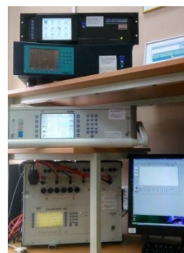
Рисунок 1 – Внешний вид национального эталона единицы электрической мощности
