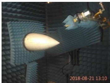
Рисунок 2 – Сканирующие устройства установлены в безэховой камере, выполненной из поглощающего материала «ТОРА 25»
