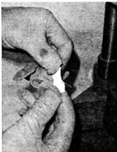
Рис.5 .24. Процесс разделения образцов, сваренных ультразвуковым методом
