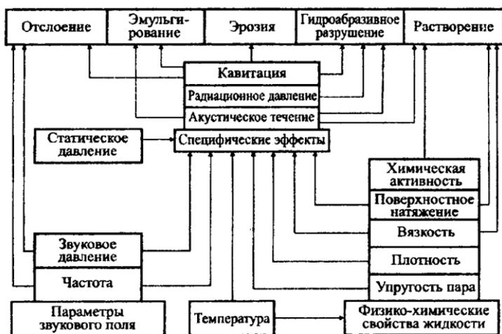
Рис. 3.1. Схема влияния различных факторов на механизм ультразвуковой очистки
