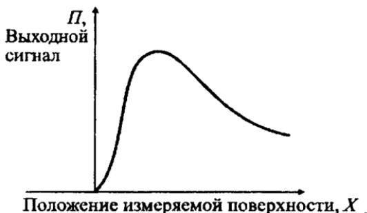
Рис. 2.4. Зависимость между измеряемым расстоянием и количеством отраженного света
