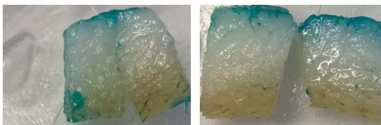
Рисунок 2 – Образец с проникновением красящего вещества
