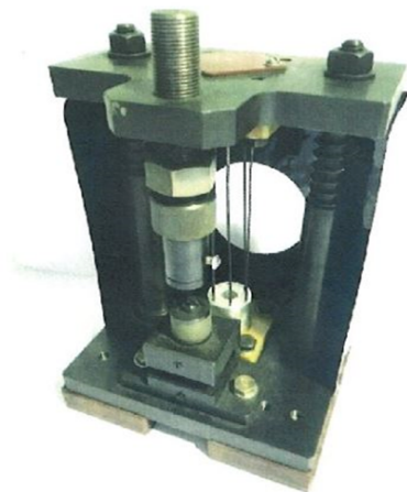
Рис. 9. Пресс с силоприводом из материала с «памятью формы»
