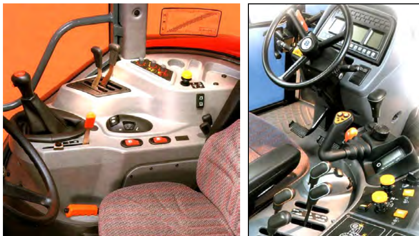
Рис. 5.1. Примеры компоновки поста управления с учетом антропометрии и биомеханики оператора
