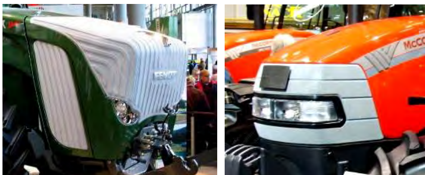
Рис. 2.5. Большие решетчатые окна в предрадиаторной зоне для обеспечения эффективного теплового режима двигателя
