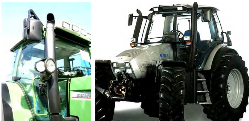
Рис. 2.14. Глушители и заборные трубы системы питания воздухом в тени стоек кабины
