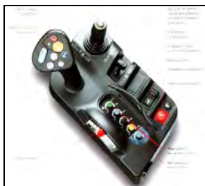
Рис. 5.2. Примеры применения джойстиков и комбинированных органов управления
