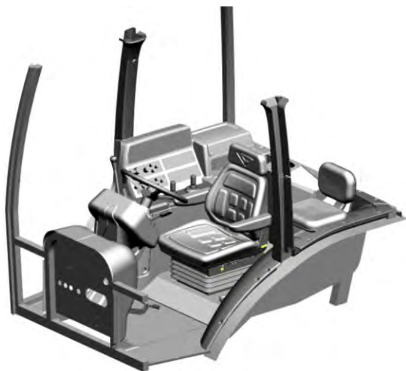
Рис. 6.3. Рабочее пространство и панели пультов управления
