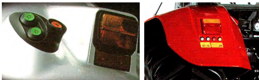
Рис. 5.4. Примеры компоновки выносных пультов управления ГНС и ВОМ
