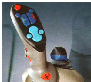
Рис. 5.2. Примеры применения джойстиков и комбинированных органов управления
