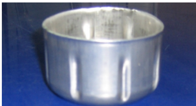
Рис. 11. Деталь, полученная с помощью комбинированной технологии «вытяжка – формовка»
