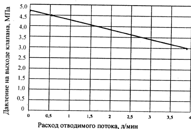
Рис. 4.2. Гидравлическая характеристика редуционного клапана
