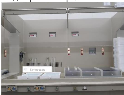
Рисунок 1 - Установка химического травления КС-01.3
