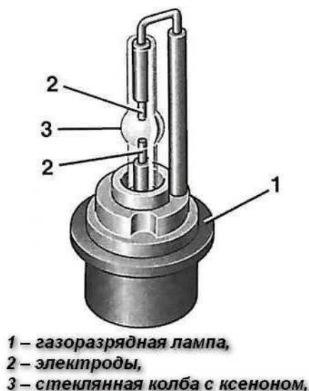
Рисунок 2 - Конструкционная схема ксеноновой лампы
