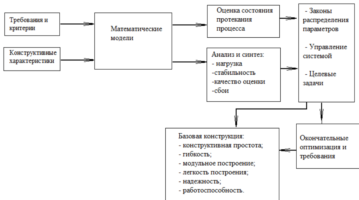
Рисунок 1 - Схема взаимосвязей основных требований к мехатронным конструкциям
