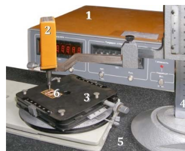
Рисунок 1 – Схема измерения-профиля поверхности п/п кристалла смонтированного в металлокерамический корпус
