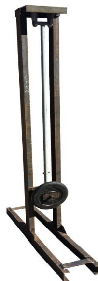
а б Рис. 2. Экспериментальная установка маятникового типа а - эскиз ударника, б – внешний вид установки
