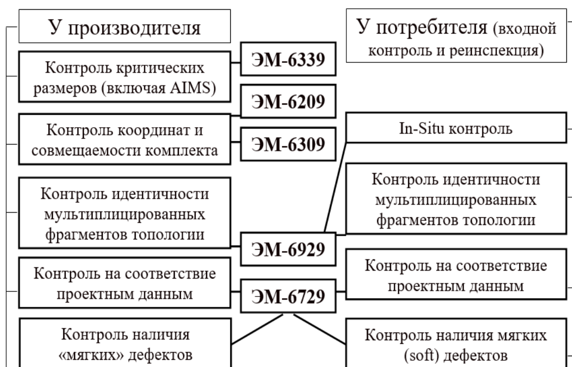
Рис. 3. Виды контроля оригиналов топологии на фотошаблонах
