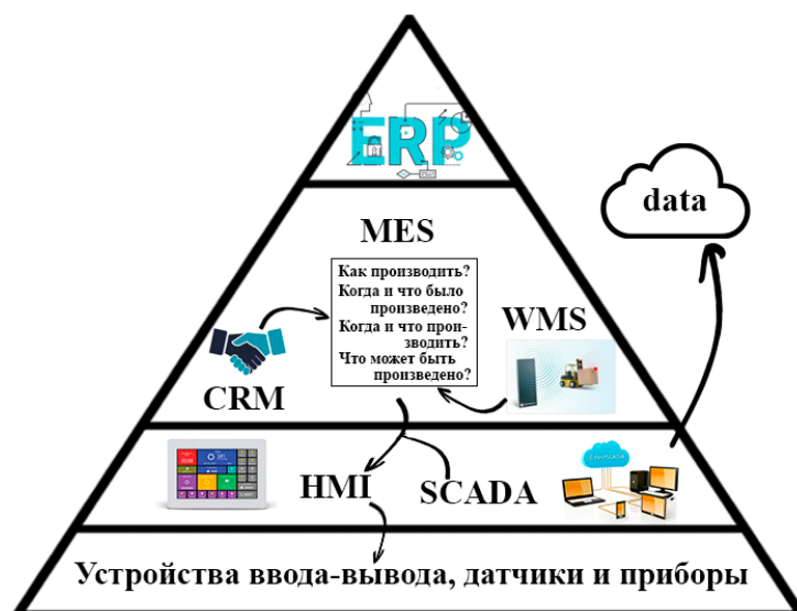
Рис. 1. Иерархия цифровой экосистемы умного производства
